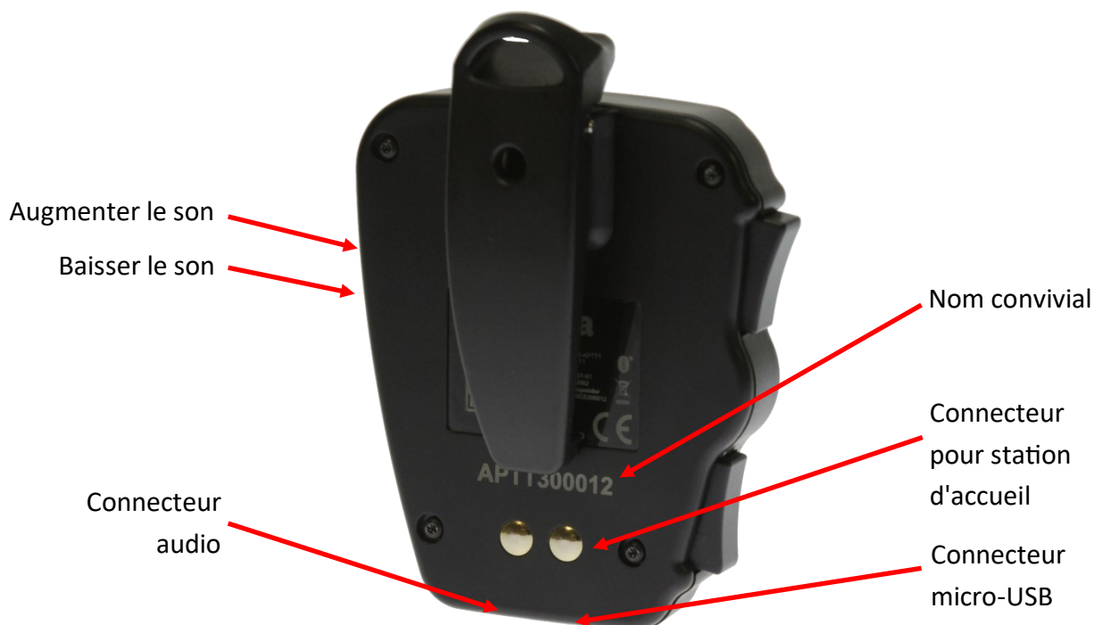
Image 2 : Vue arrière et connecteurs
