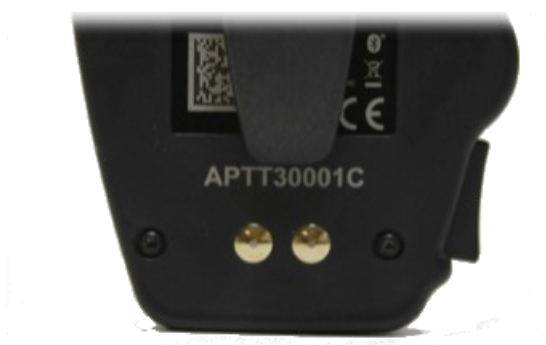
Image 3 : Nom convivial imprimé en bas à l'arrière de PTT Voice Responder (image d'exemple).
